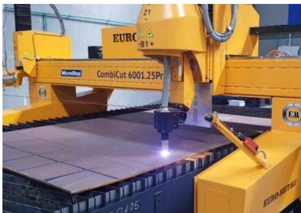
Euro – metali, vodeći distributer u oblasti metalurgije u Bosni i Hercegovini, investicijom u nova tehnološka rješenja obrade metala ušao je u novi segment poslovanja. Tako je u Doboju Jugu instaliran CNC plazma - rezač koji siječe limove debljine do 40mm i CNC gasni rezač koji može rezati limove debljine do 200mm, a riječ je o posljednjoj generaciji CNC mašina sa 3D glavom, navodi se u saopćenju Euro – metala.
